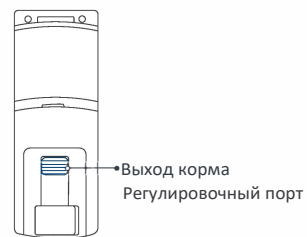
[Регулировка выходного отверстия для корма]
